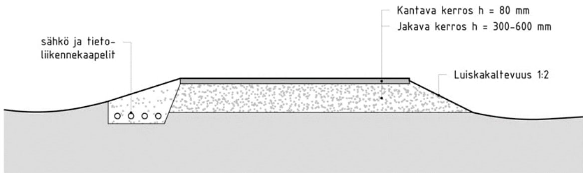
Periaatekuva uuden ja perusparannettavan tien rakenteesta.
